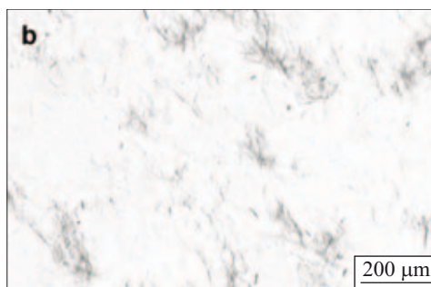
Rys. 2. Obrazy mikroskopowe zawiesiny nanorurek węglowych w roztworze po 1,5 min (a) i po 30 min (b) od zakończenia dyspergowania przy użyciu ultradźwięków Fig. 2. Optical microscope pictures of dispersion of CNTs in ethylene chloride solution after: a) 1.5 min, b) 30 min after sonification
