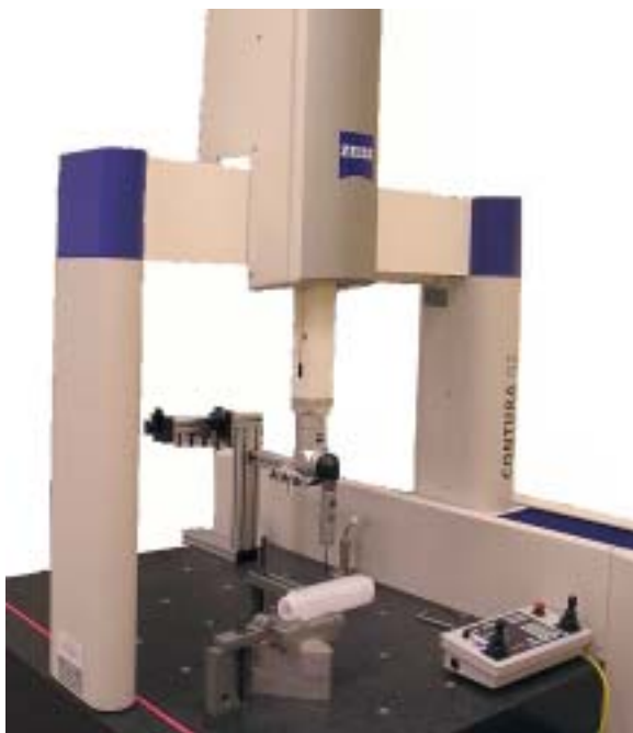
Rys. 3. Urządzenie Contura® G2 RDS do wyznaczania skurczu i odkształceń Fig. 3. Contura® G2 RDS unit for determination of shrinkage and deformations
