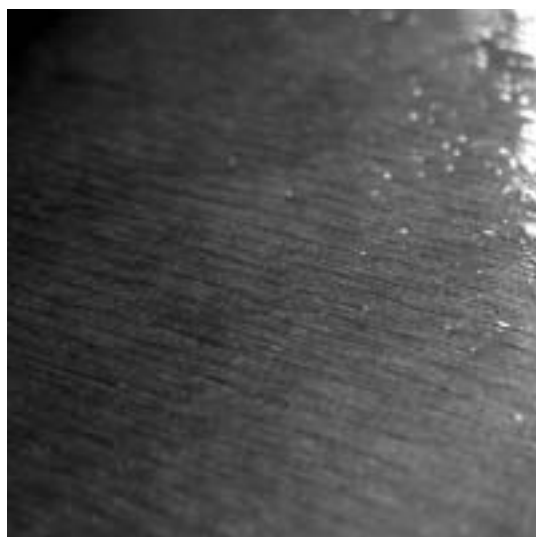
Rys. 4. Powłoka wykonana z poliestru C naniesiona na podłoże drewniane i utwardzona promieniowaniem UV
