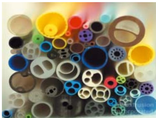
Rys. 4. Widok wytłoczyn o małych wymiarach z wieloma funkcjonalnymi kanałami [26]
