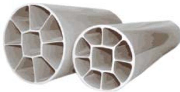
Rys. 3. Widok wytłoczeń o dużych wymiarach z wieloma funkcjonalnymi kanałami [19]
