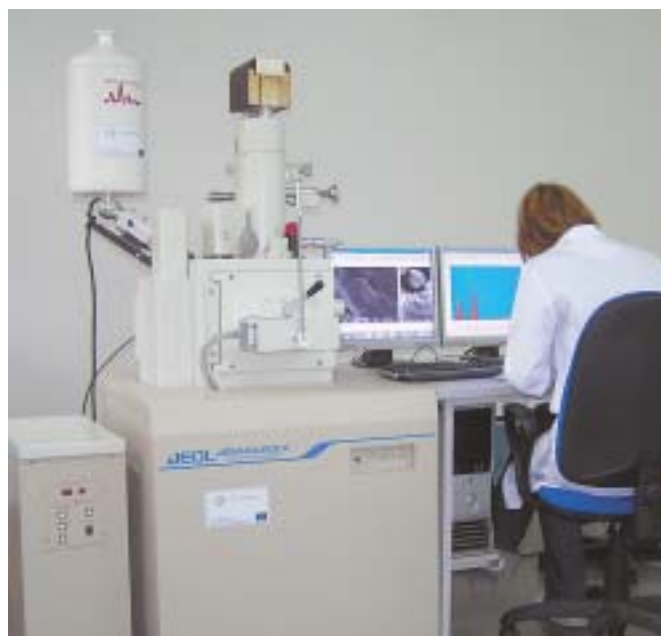
Fot. 2. Niskopróżniowy mikroskop skaningowy JSM-6490LV
