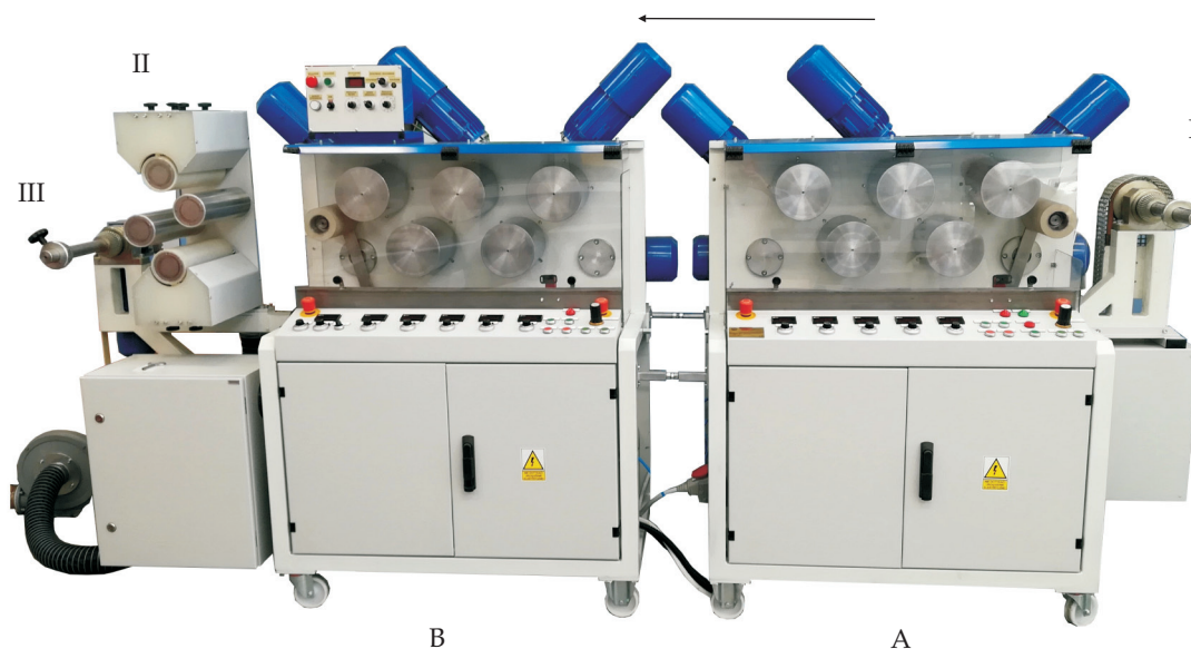
Rys. 1. Widok ogólny urządzenia do jednoosiowej orientacji folii kompozytowych Fig. 1. General view of device for uniaxial orientation of composite films
