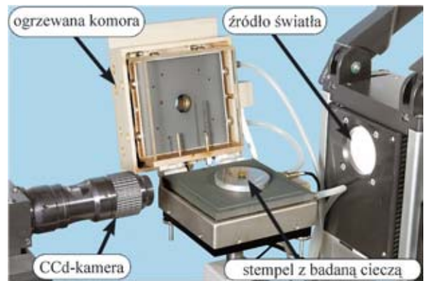
Rys. 3. Ogrzewana komora (otwarta) do pomiaru metodą stempla napięcia powierzchniowego ciał stopionych
