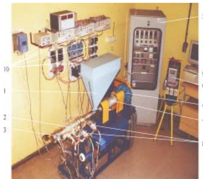
Rys. 1. Wygląd ogólny stanowiska badawczego: 1 — zasobnik tworzywa, 2 — cylinder segmentowy, 3 — głowica wytłaczarska, 4 — silnik napędowy, 5 — szafa sterownicza, 6 — licznik energii prądu elektrycznego, 7 — momentomierz, 8 — czujniki pomiaru ciśnienia i temperatury, 9 — komputer, 10 — elementy układu pomiarowego
