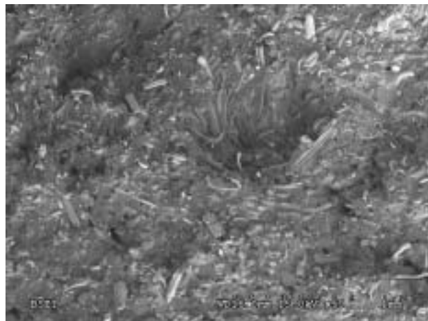
Rys. 8. Struktura (SEM) kompozytu PE-LD + 30 % mas. odpadu dywanowego o runie z PAN + PA66
