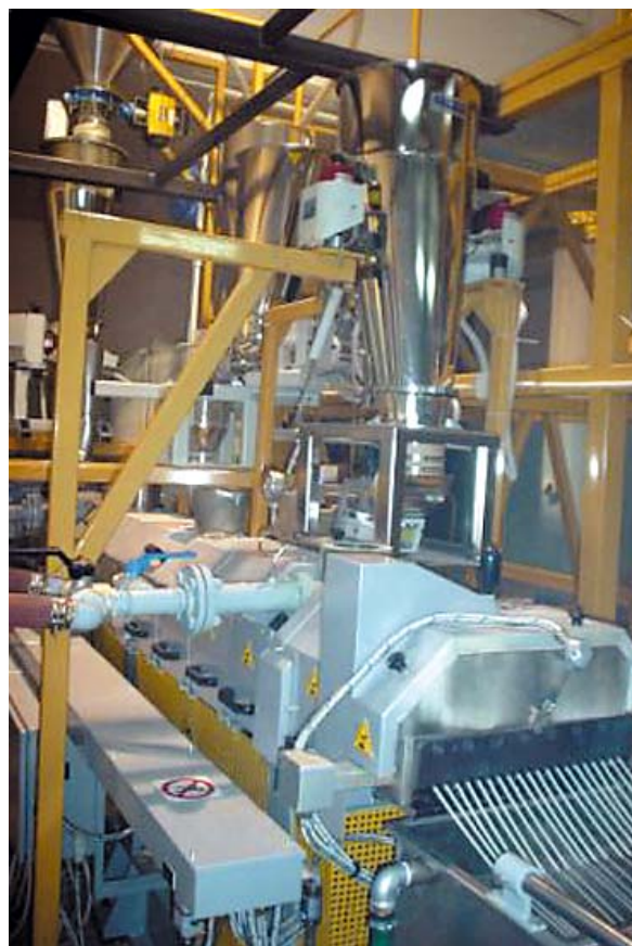
Fot. 3. Linia produkcyjna do wytwarzania tworzyw Reylan (wydajność 150/200 kg) (fot. Piotr Krzyżanowski)
