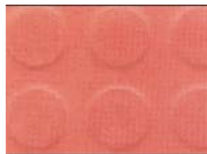
Rys. 11. Wykładzina podłogowa z kompozytu PVC + fosfogips Fig. 11. Flooring made of PVC composite with phosphogypsum
