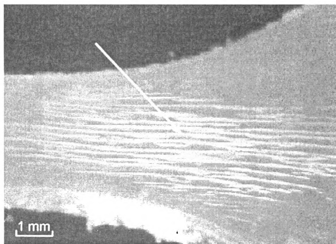
Rys. 5. Zdjęcie próbki wypraski wtryskowej („Malen PJ-400”) po badaniu odporności na powolny wzrost pęknięć z zaznaczonymi rysami naprężeniowymi powstałym podczas wycinania próbki, ustawionymi w kierunku przepływu tworzywa w formie wtryskowej i w kierunku osi obciążenia próbki
