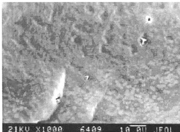
Rys. 1. Zdjęcie mikroskopowe SEM wulkanizatu otrzymanego z mieszanki zawierającej 10 phr DAMS
