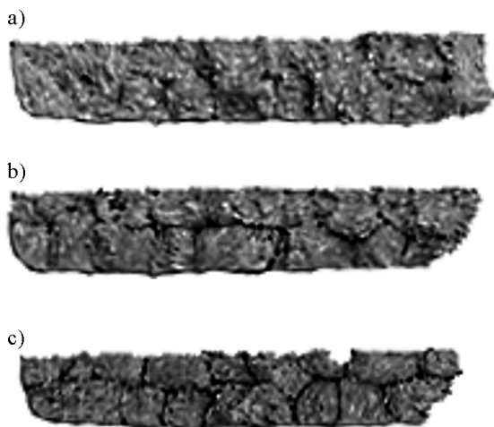
Rys. 8. Próbkki kompozytu uzyskane w procesie wytłaczania z różną prędkością obrotową ślimaka, pobrane ze zwoju 16 (przekrój poprzeczny): a) N = 20 obr/min, b) N = 50 obr/min, c) N = 80 obr/min
