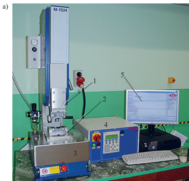
Rys. 2. a) Stanowisko do zgrzewania wibracyjnego: 1 – zespół przesuwający z oprzyrządowaniem górnym, 2 – głowica wibracyjna z oprzyrządowaniem dolnym, 3 – pulpit sterujący, 4 – układ sterowania, 5 – przyrząd pomiarowy VibRecord; b) widok próbek zamocowanych w oprzyrządowaniu
