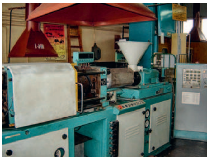
Rys. 1. Stanowisko badawcze wtryskiwania porującego Fig. 1. Test stand for cellular injection molding process
