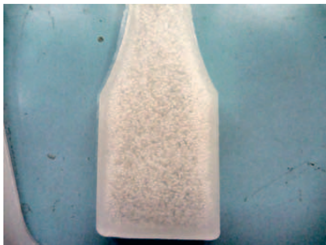
Rys. 3. Fragment porowanej wypraski wtryskowej z widoczną strukturą porowatą
