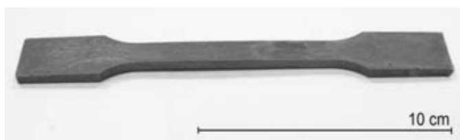
Rys. 2. Próbkę wykonana z kompozytu LL 21 Fig. 2. A sample made of composite LL 21
