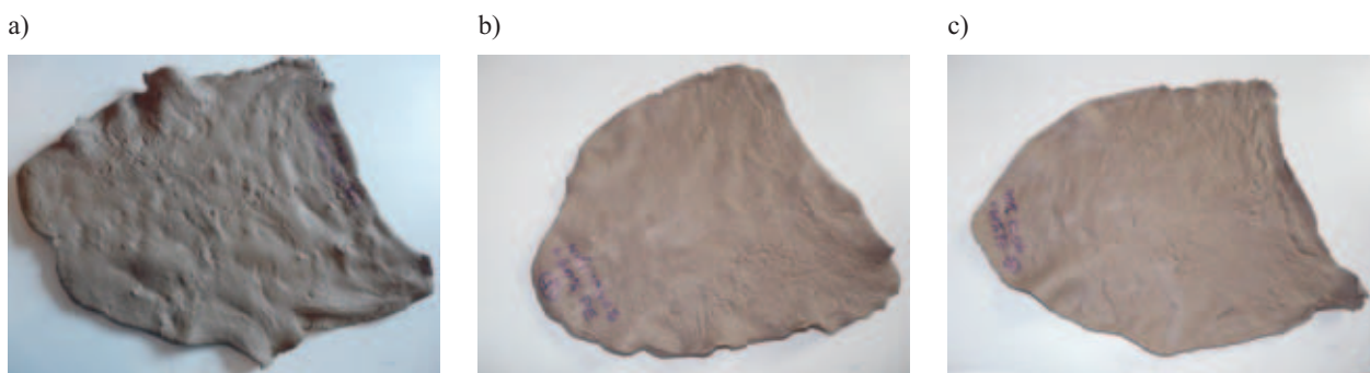
Rys. 1. Zdjęcia mieszanek po procesie walcowania: a) LL 21, b) LW 23 i c) LK 18 Fig. 1. Pictures of the blends after the rolling process: a) LL 21, b) LW 23 and c) LK 18
