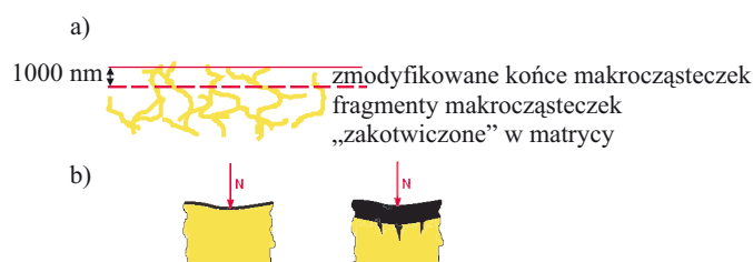
Rys. 8. Schematy ilustrujące odporność na ścieranie (a) i trwałość zmęczeniową (b) warstwy wierzchniej polimeru poddanej bombardowaniu jonowemu
