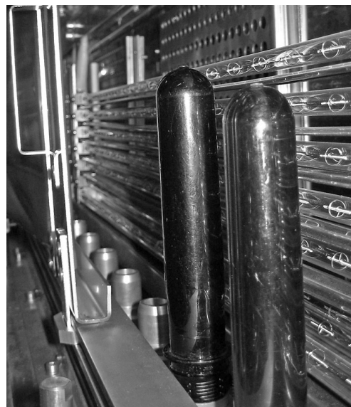
Rys. 1. Wnętrze tunelu ogrzewającego preformy w maszynie do wytwarzania opakowań metodą rozdmuchiwania z rozciąganiem
