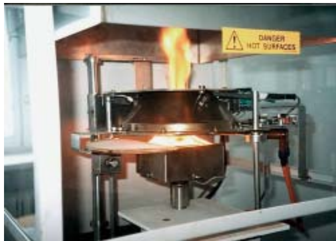
Rys. 1. Spalanie próbki w kalorymetrze stożkowym Fig. 1. Combustion of the sample in conical calorimeter
