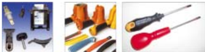
Rys. 5. Przykłady wyprasek uzyskanych metodą otryskiwania wstawek wewnętrznych [28, 31]
